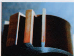
▲ダイナミックウォーター ジェットによる加工
